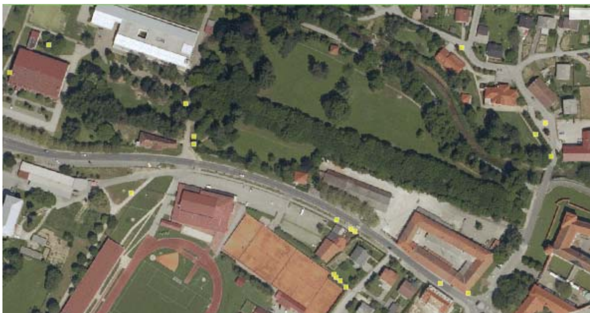
Slika: Primer kritičnega odseka vodovodnega sistema s prikazom okvar
